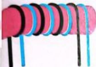
$$B_1 = B_{1\text{ داخلي}} + B_{2\text{ داخلي}} \quad \text{في نفس الاتجاه:}$$
