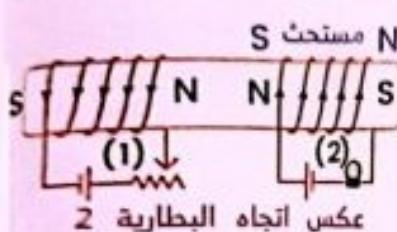
عند زيادة ربوستات 1 يقل تياره، فيعمل كمغناطيسي يبتعد بشماله فيقل الفيض، فيتولد في 2 قطب جنوب مستحث مواجه للقطب الشمالي في الملف 1 أي يكون التيار المستحدث في عكس اتجاه التيار الأصلي فيقل تيار 2 لحظياً أي تقل إضاءة المصباح لحظياً.
