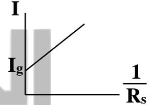
العلاقة  $I = \frac{I_g (R_g + R_s)}{R_s}$
